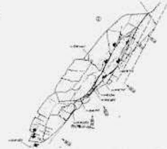
図-1 不安定岩盤のスケッチ例 (高さ約15m)
