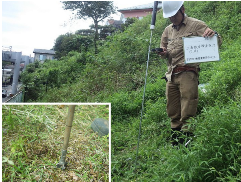
写真-2 ベーンせん断試験の状況
