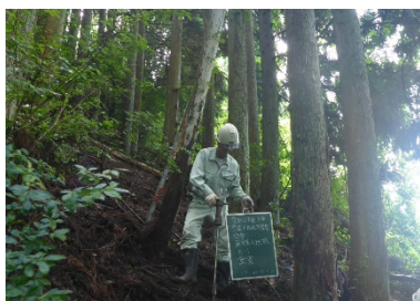
写真-1 簡易動的コーン貫入試験状況
