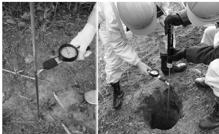
土層強度検査棒 ベーンコーンせん断試験の様子
